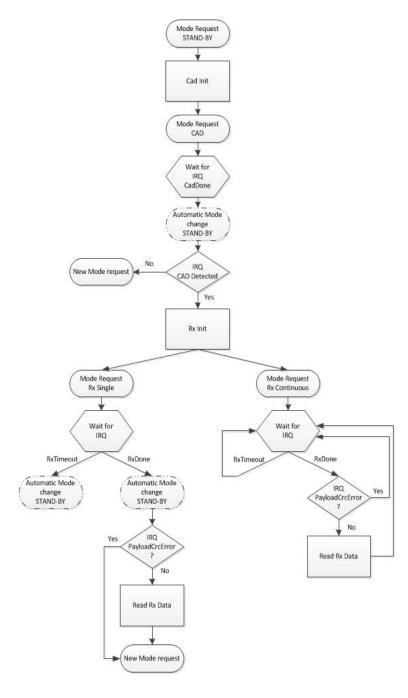
Figure 10. LoRa<sup>TM</sup> CAD flow
