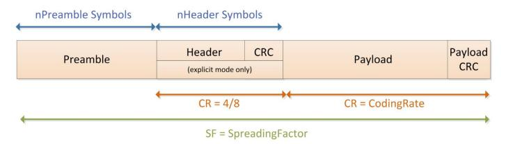
Figure 5. LoRa<sup>TM</sup> Packet Structure
