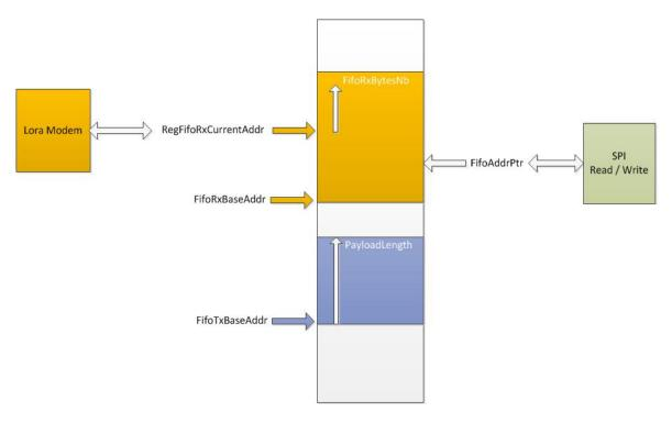
Figure 7. LoRa<sup>TM</sup> data buffer
